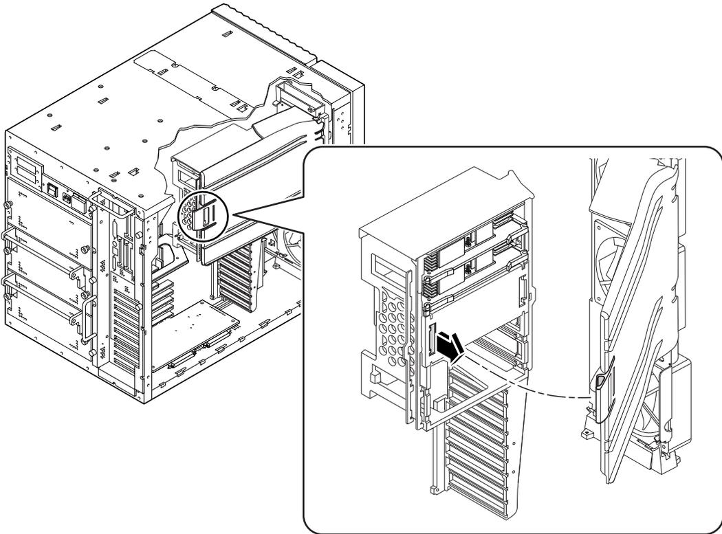
**2. Desenganche las lengüetas de la guía de aire del conjunto de la bandeja del ventilador de la CPU.**
