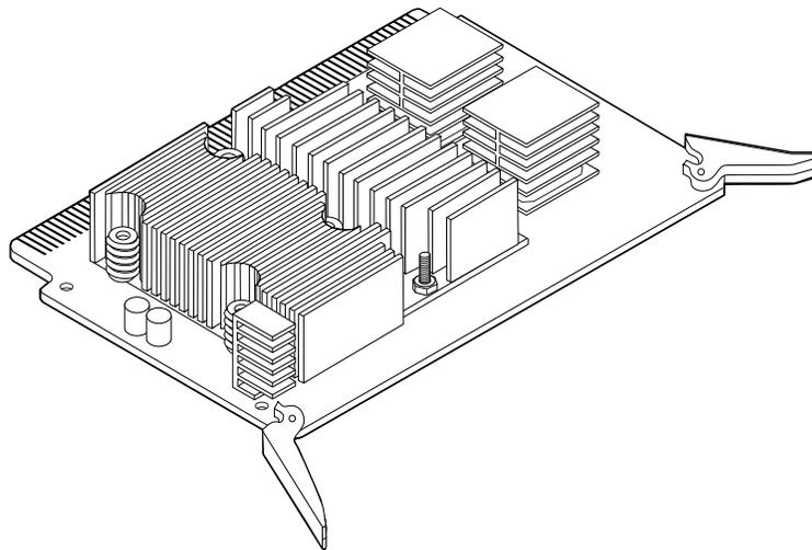
Avant d'installer un module processeur, vérifiez qu'il figure bien parmi les modules UltraSPARC II suivants (pour les serveurs Sun Enterprise 450). Le tableau suivant indique les vitesses des modules processeur.
