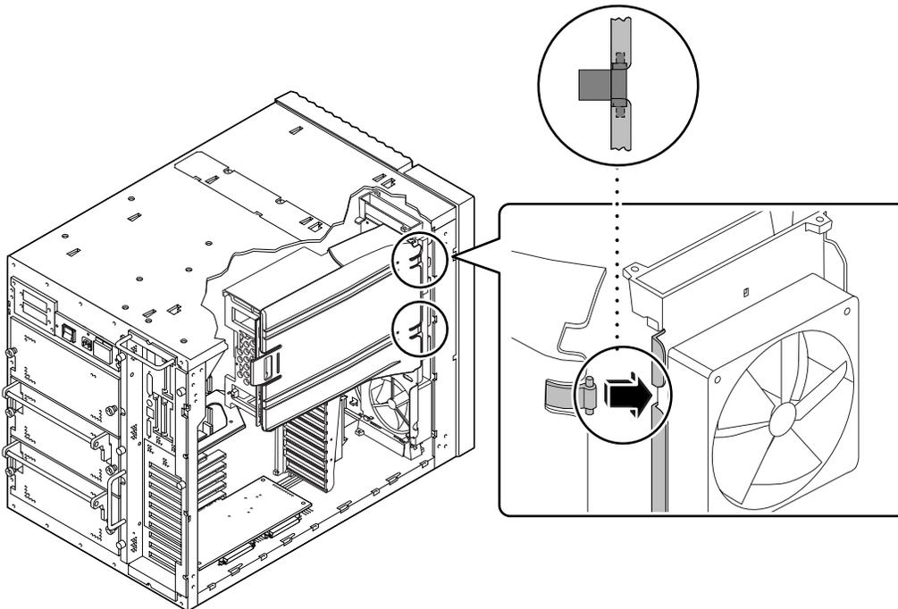
2. **Deslice la guía hacia la parte posterior de la estructura para fijar las lengüetas al conjunto de la bandeja del ventilador.**
