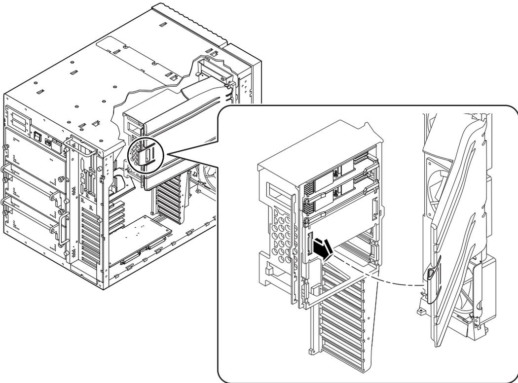
**2. Retirez les fiches maintenant le conduit sur le dispositif d'aération du processeur.**
