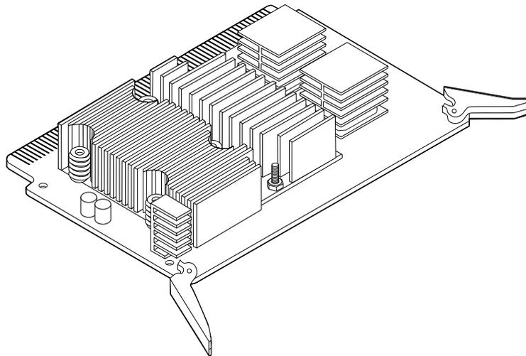
Prima di installare un modulo CPU, verificare che si tratti di uno dei seguenti moduli UltraSPARC II per server Sun Enterprise 450. La tabella seguente riporta le velocità in MHz dei vari moduli CPU.
