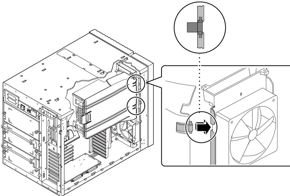
2. **Schieben Sie das Lüftungsgitter zur Rückseite des Chassis, bis die Stifte des Lüftungsgitters in dem CPU-Lüftereinschub einrasten.**
