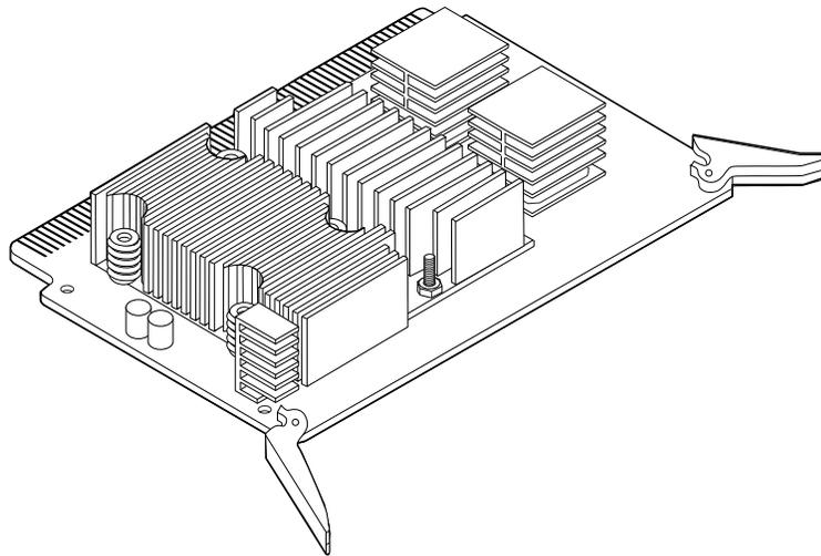
Antes de instalar cualquier módulo, compruebe si pertenece a uno de los siguientes tipos de módulos UltraSPARC II para servidores Sun Enterprise 450. En la tabla siguiente se indican las distintas frecuencias disponibles.
