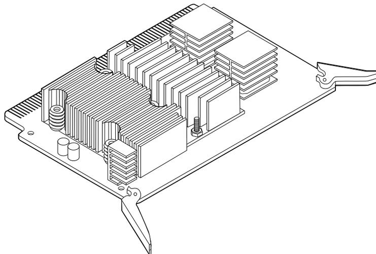
Bevor Sie ein CPU-Modul einbauen, überprüfen Sie, ob es sich bei dem Modul um eines der folgenden UltraSPARC II-Module für Sun Enterprise 450-Server handelt. In der folgenden Tabelle sind die Taktfrequenzen der verschiedenen CPU-Module aufgeführt.
