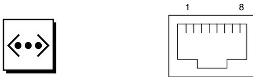
**FIGURE 11-6** RJ45 TPE Socket
