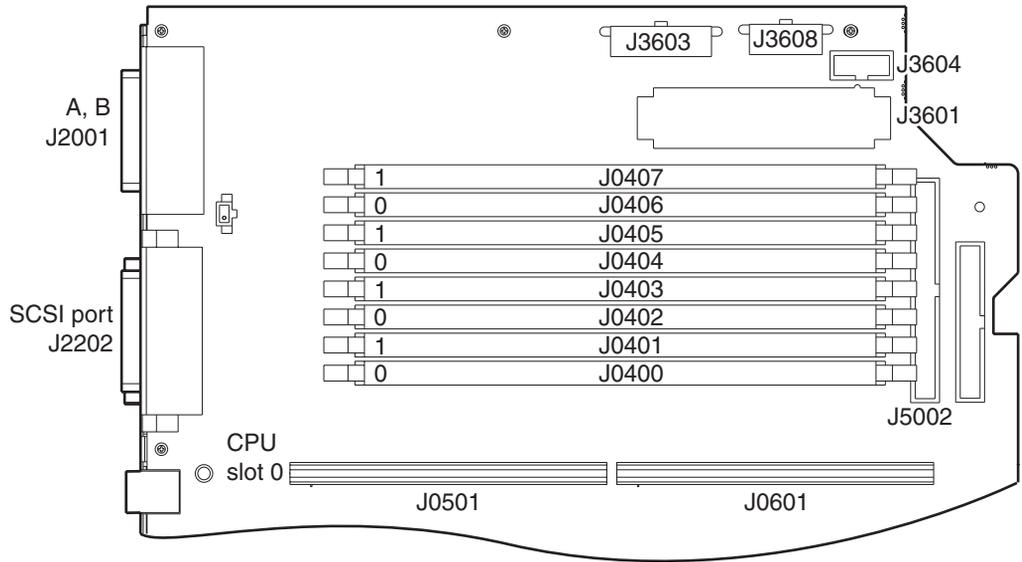
FIGURE 10-6 DIMM Mapping
