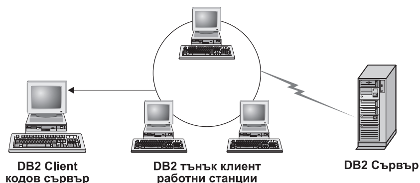
Фигура 1. Типична топология на тънък клиент с използване на DB2 клиента
